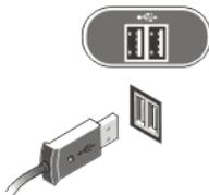
**Ilustración 4. Conexión del teclado y el ratón**
